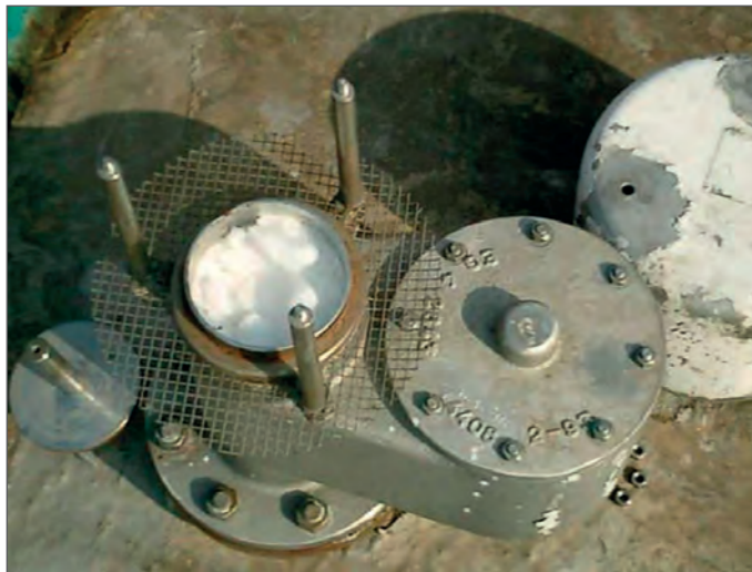
Verstopfung durch kristallisierte Essigsäure
