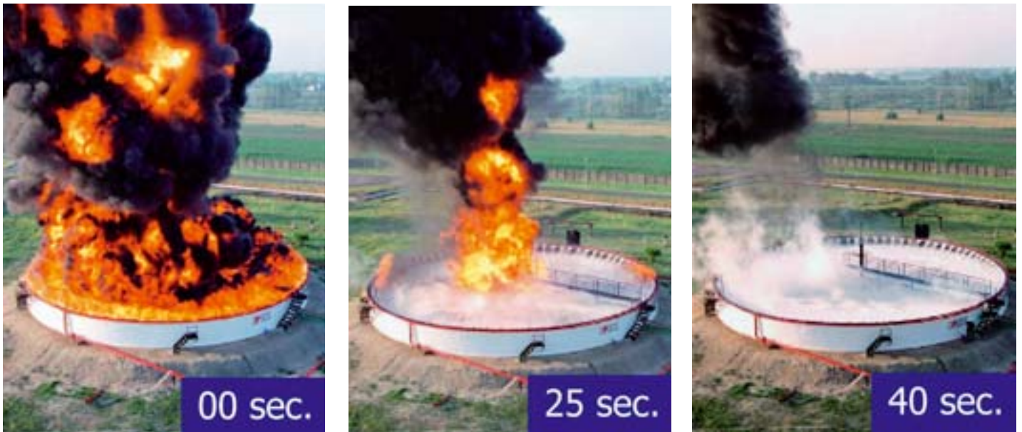
Bild 3: Löschversuche mit der FoamFatale-Technologie
