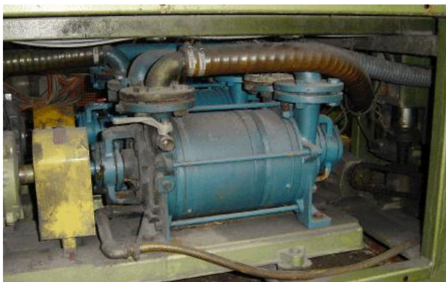
Abb.3: 2-stufige Vakuumpumpen für die Kunststoffprofilkalibrierung
